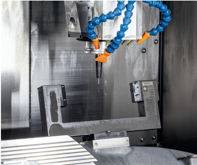
2 Das Werkzeugspektrum ist groß, daher wird das Lasermesssystem Micro Compact NT für verschiedenste Aufgaben eingesetzt
